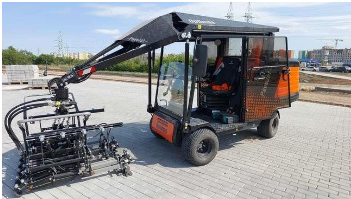
Рисунок 3 – Общий вид самоходной машины для укладки тротуарной плитки
