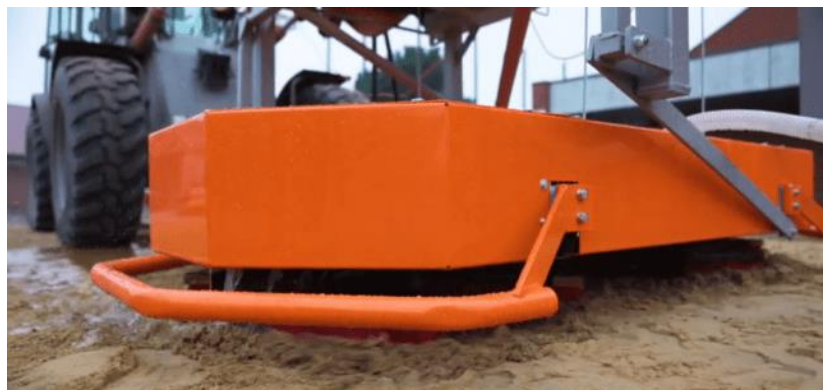
Рисунок 8 – Заполнение швов плитки песком
